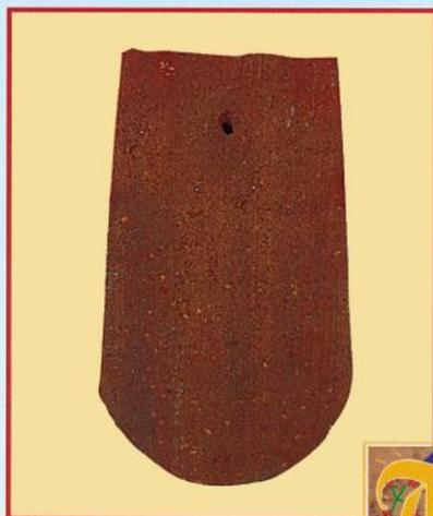
La tuile Gironnée est utilisée pour la couverture de tours. Elle est spécialement découpée en usine en deux formats standards 15 x 27 et 13 x 23 de forme écaille ou rectangulaire. Sur demande, elle peut-être réalisée dans d'autres formats.
