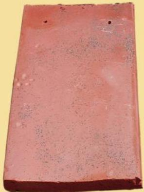
La tuile Flammée est fabriquée à partir d'argiles de très grande qualité cuites à 1080°. La cuisson «en réduction» permet d'obtenir une toiture aux tons chauds alliant les ocres, le brun flammé et les gris de Beaune.
