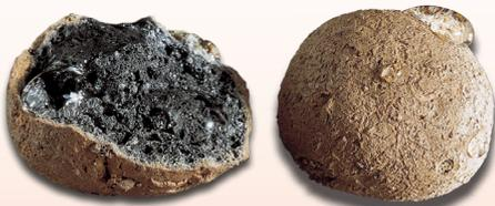
L'argile expansée **Laterlite Più** est un agrégat léger et isolant obtenu avec seulement de l'argile naturelle, expansée et clinckérisée à 1200° C, caractérisée par une structure interne cellulaire enfermée dans une écorce dure et résistante.
