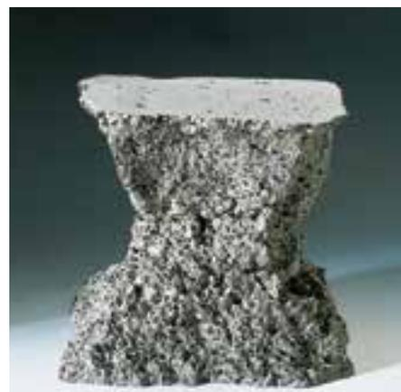
Éprouvette cubique de béton structural léger après test de résistance à la compression.
