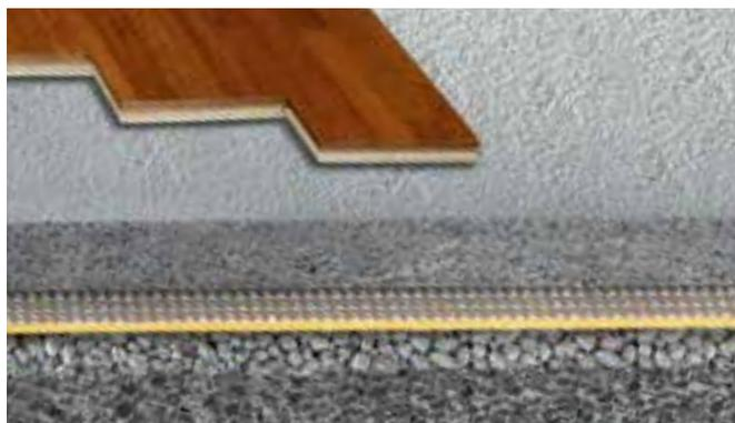
La solution envisage la pose sur le support en bois d'une seule couche de chape légère ou technique (conformément au DTU 26.2), séparée du plancher en bois par une membrane imperméable respirante. La solution peut être complétée avec différentes couches additionnelles, pour des exigences acoustiques, thermiques ou de contrôle de l'humidité.
