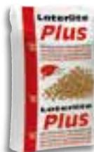
Granulats légers d'argile expansée spéciale, secs et hydrophobes (absorption d'eau environ 1% à 30 minutes), caractérisés par une structure interne cellulaire comprise dans une écorce dure et résistante clinckérisés à 1200°C. Disponibles en différentes granulométries, types et résistances.
