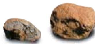
Argile Expansée Laterlite Structurale
